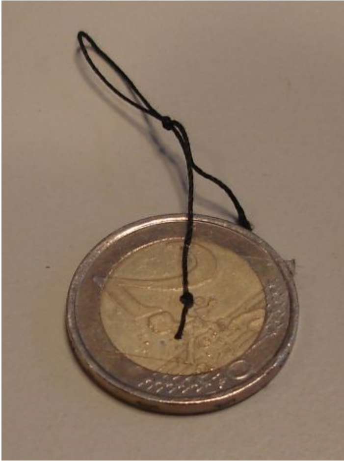
Eine 2-Euro Münze mit einer Garnschleife als Prüfgewicht.
